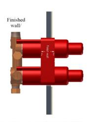
Wall template cut out, finished wall / Gabarit de mur pour découpage, mur fini
